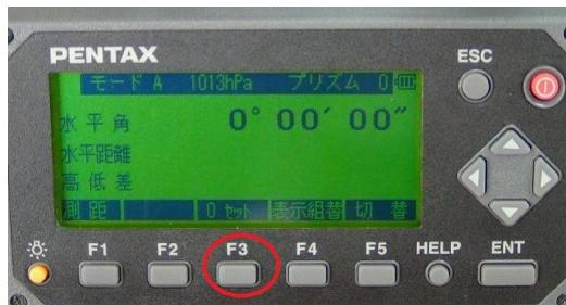
F5で[切替] (上の左側にモードA・モードB 表示されます。)
