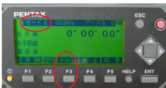
(F5で[切替]) モードB F3で[ホールド]で 水平角の固定(F5で切替)
